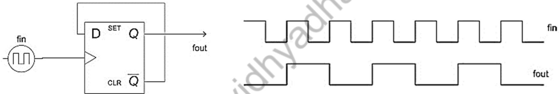
$$T_{\text{minimum}} \geq T_{\text{setup\_time}} + T_{\text{clock\_Q}} + \text{dly}$$
